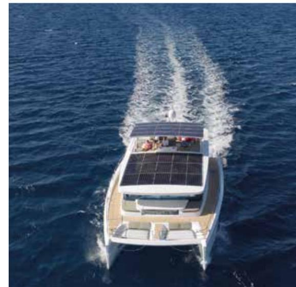
Das resultierende Konzept, welches durch Solarpaneele auf dem Dach die komplette Energieversorgung des Bootes mit Hilfe von Lithium Batterien speist, hatte sich mehr als nur bewährt. Der entwickelte Solarantrieb war in Sachen Effizienz und Innovation jedem herkömmlichen Antrieb deutlich überlegen. Dieses technologische Zusammenspiel bietet den Passagieren neue Dimensionen und Vorzüge in Sachen Luxus und Komfort.
